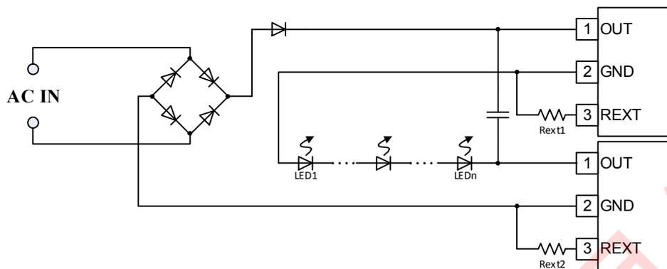
图 7. PT4515G 填谷电路应用电路原理图 2
