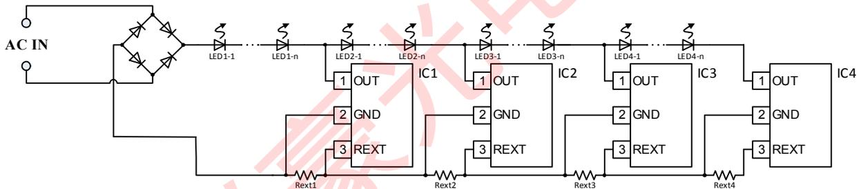
图 5. PT4515G 串联应用电路原理图
